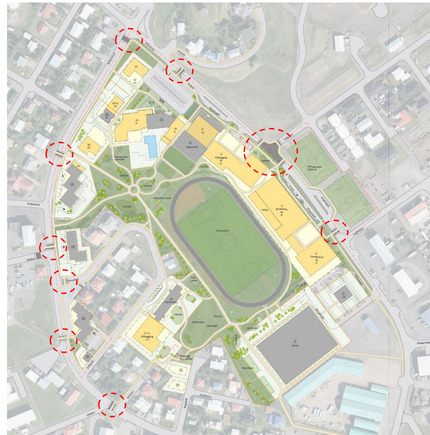
Mynd 8 Rauðir hringir sýna staðsetningu gönguþverana á svæðinu og jafnframt hvar aðkoma fyrir fótgangandi er inn á svæði
